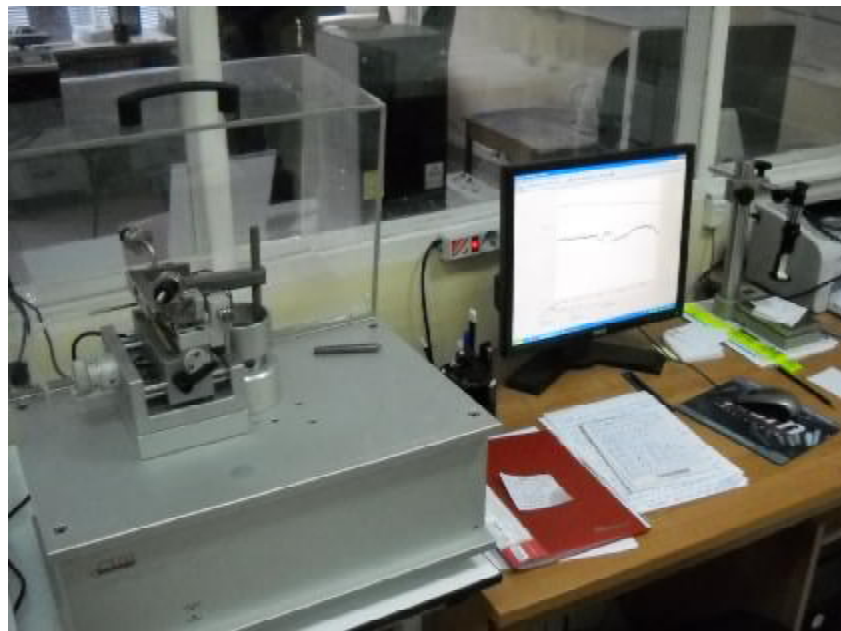
Fig. 1. Tribometer conjunction TRB – S – DE
